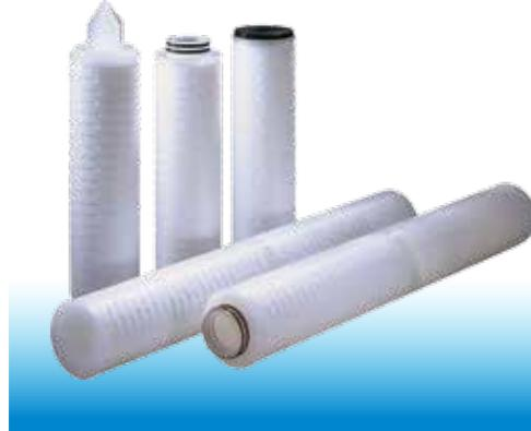
Tech-Flowシリーズカートリッジは耐薬品性に優れた延伸ポリテトラフルオロエチレン(ePTFE)メンブレンで製造され、疎水性あるいは親水性の特性が持っています。均一な孔径の構造で、ePTFEメンブレンは細微粒子の捕捉効果が抜群。識別・追跡するため、全ての商品にろ過精度とロット番号を刻印しています。ポリプロピレン(PP)樹脂製のハードウェアを採用すると共に、幅広い化学品液体に対応可能です。
