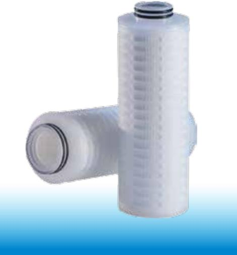
Mega-Flowシリーズカートリッジは大ろ過面積構造で、 TFT-LCD製造プロセスである洗浄装置、及び高純度水用 フィルターとして、大流量処理に使用されています。高 純度ポリプロピレン(PP)樹脂のハードウェアは幅広い 化学品液体に対応可能です。コンパクトデザインのプリ ーツカートリッジを採用し、フィルターの寿命が伸びる ことで、ダウンタイムが短縮され、運用コストを最小限 抑えます。本製品は、Filtrafine Top-Flowシリーズフィルタ ーハウ징をセットして使用されます。
